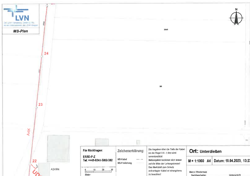
Abb. 3 20kV-Freileitung (bezeichnet mit „A4K“), Quelle: LEW Verteilnetz GmbH (LVN), Stand 19.04.23
